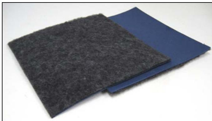
Fig. 1. Il campione in esame Isolmant UnderSlim
