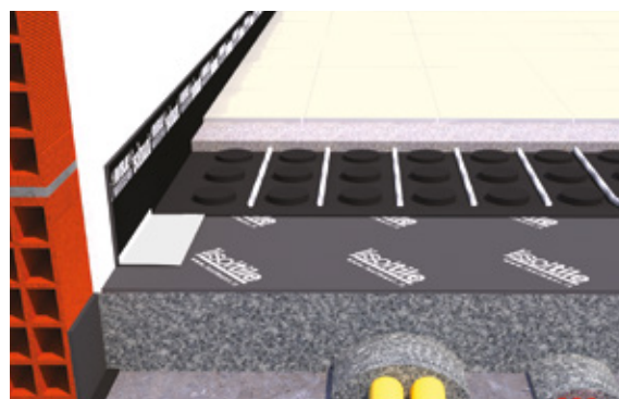
↑ Isolmant IsolTile in applicazione sottomassetto con spessore inferiore a 3 cm in presenza di riscaldamento a pavimento.
