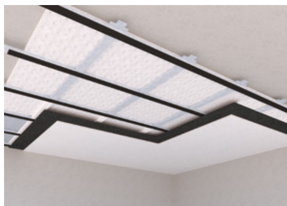
↑ Controsoffitto a basso spessore e finitura a singola lastra con IsolGypsum Telogomma o IsolGypsum Perfetto 10 mm avvvitabile
