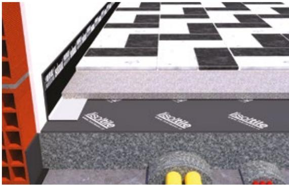
↑ *Isolant IsolTile in applicazione sottomassetto con spessore inferiore a 3 cm.*
