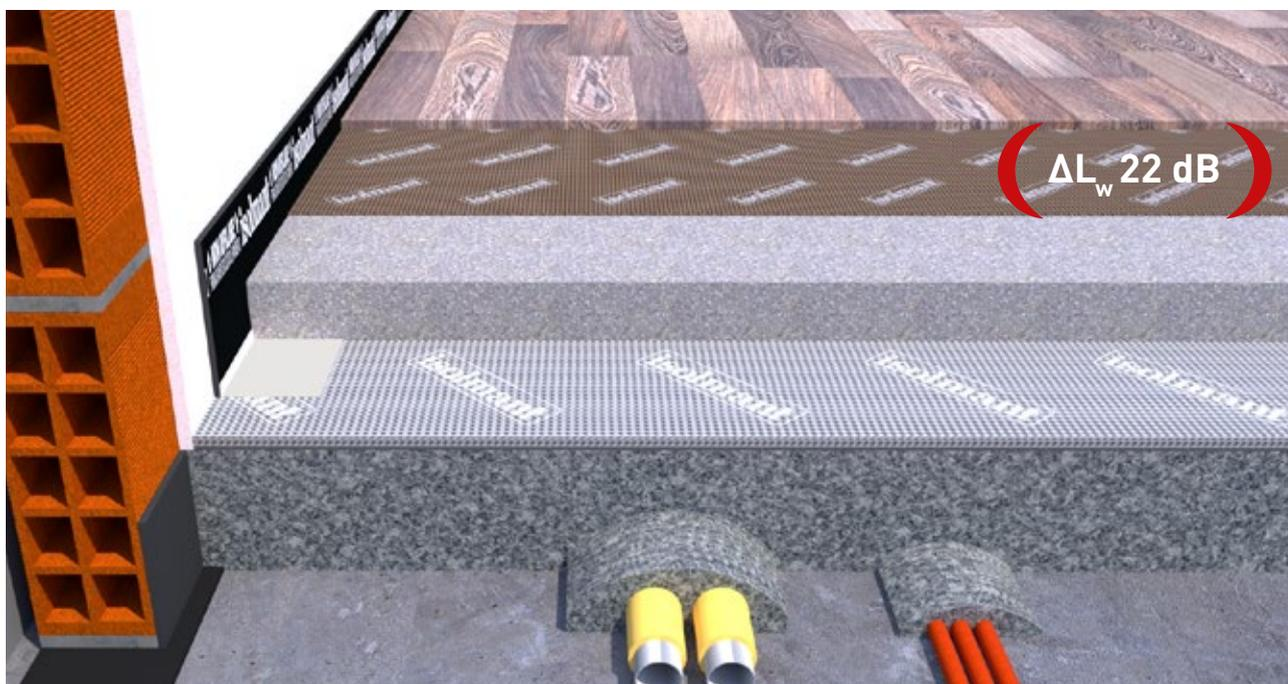
↑ *Isolmant Special 2 mm Fossil Free è realizzato con materiale di derivazione non fossile. Una nuova soluzione per la posa flottante del parquet.*
