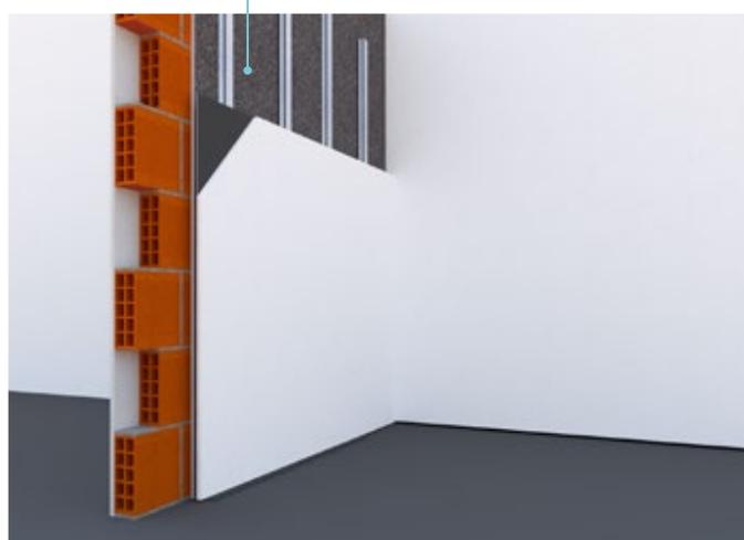
↑ *Una soluzione di questo tipo con Isolmant Polimuro incrementa il potere fonoisolante della parete fino a 14 dB.*
