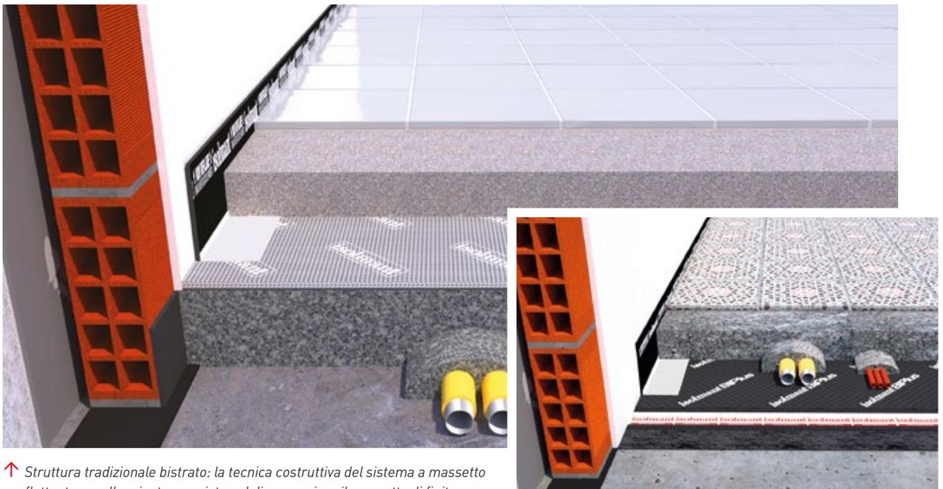
↑ *Struttura tradizionale bistrato: la tecnica costruttiva del sistema a massetto flottante, o galleggiante, consiste nel disaccoppiare il massetto di finitura e la pavimentazione dalle strutture limitrofe mediante uno strato di materiale elastico posto al di sotto del massetto di supporto alla pavimentazione, e lungo il perimetro del locale.*
