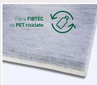
IsolGypsum Perfetto sfrutta la tecnologia di IsolFibtec, la speciale fibra di Isolmant, riciclata in tessile tecnico derivato da PET. La particolare densità crescente lungo lo spessore ne esalta le prestazioni acustiche e termiche. Si tratta inoltre di un materiale totalmente ecologico, anallergico e riciclabile.
