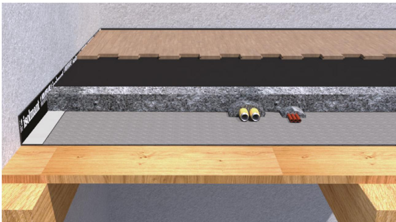
↑ *In un solaio leggero, sia esso bistrato o monostrato, la richiesta di uno strato acustico massivo può essere soddisfatta con Isolmant Telogomma E+45 in presenza di massetti ad alto spessore o laddove sia richiesto anche un incremento dell'isolamento al rumore aereo, mentre si sceglierà Isolmant Telogomma TT in presenza di massetti a basso spessore.*
