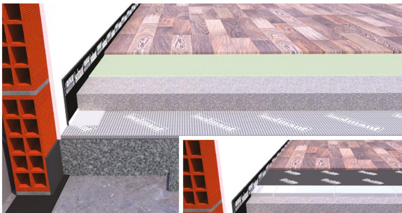
↑ La posa ibrida con *Isolmant Top Incollapavimento* può essere effettuata anche in presenza di riscaldamento a pavimento e nella modalità "posa su posa", ovvero posando la nuova finitura su quella esistente.
