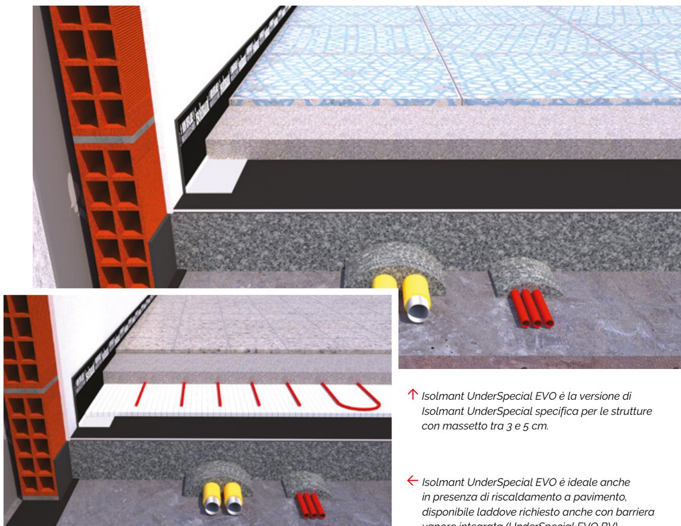
↑ *Isolmant UnderSpecial EVO è la versione di Isolmant UnderSpecial specifica per le strutture con massetto tra 3 e 5 cm.*
