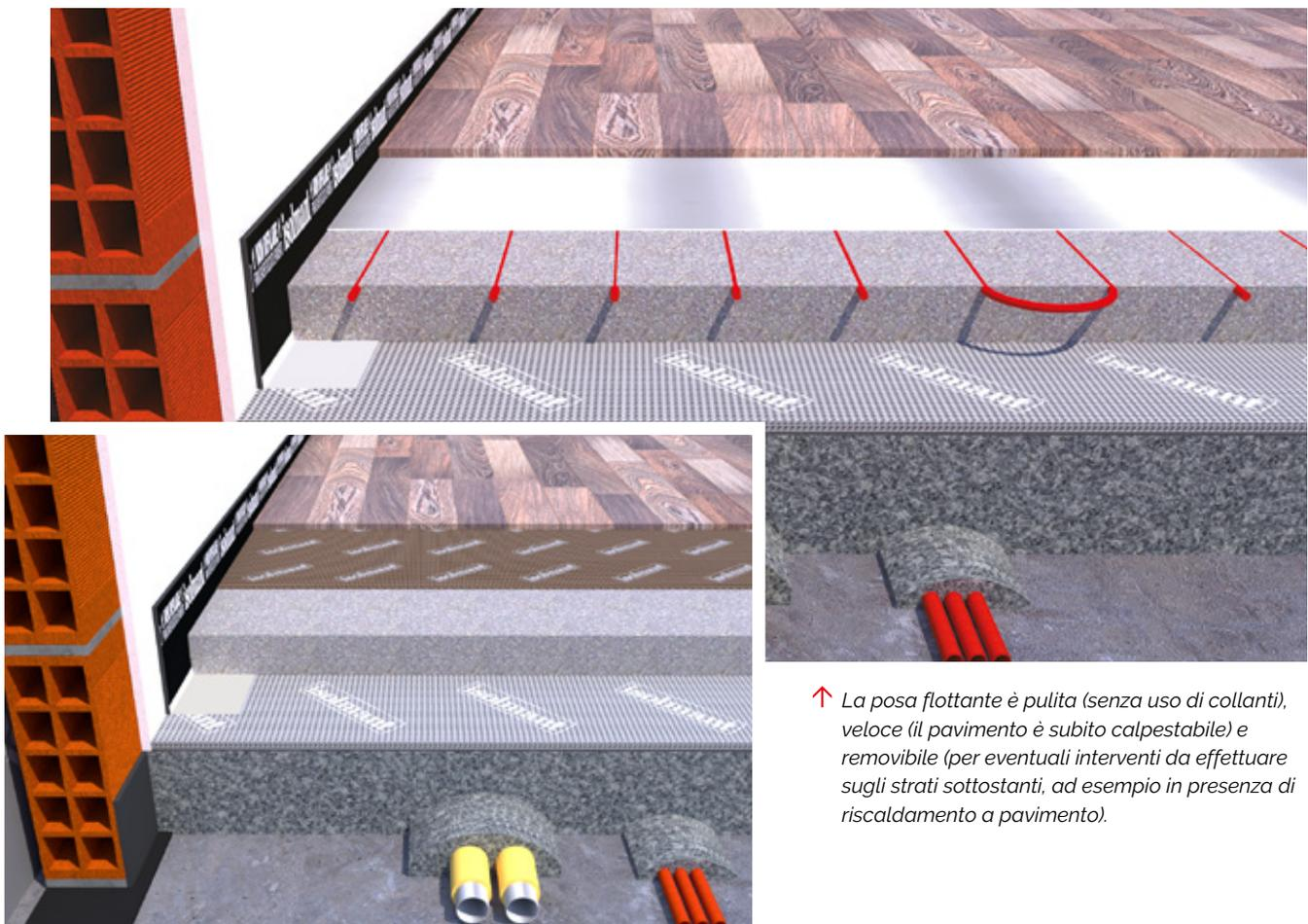
↑ *La posa flottante è pulita (senza uso di collanti), veloce (il pavimento è subito calpestabile) e removibile (per eventuali interventi da effettuare sugli strati sottostanti, ad esempio in presenza di riscaldamento a pavimento).*
