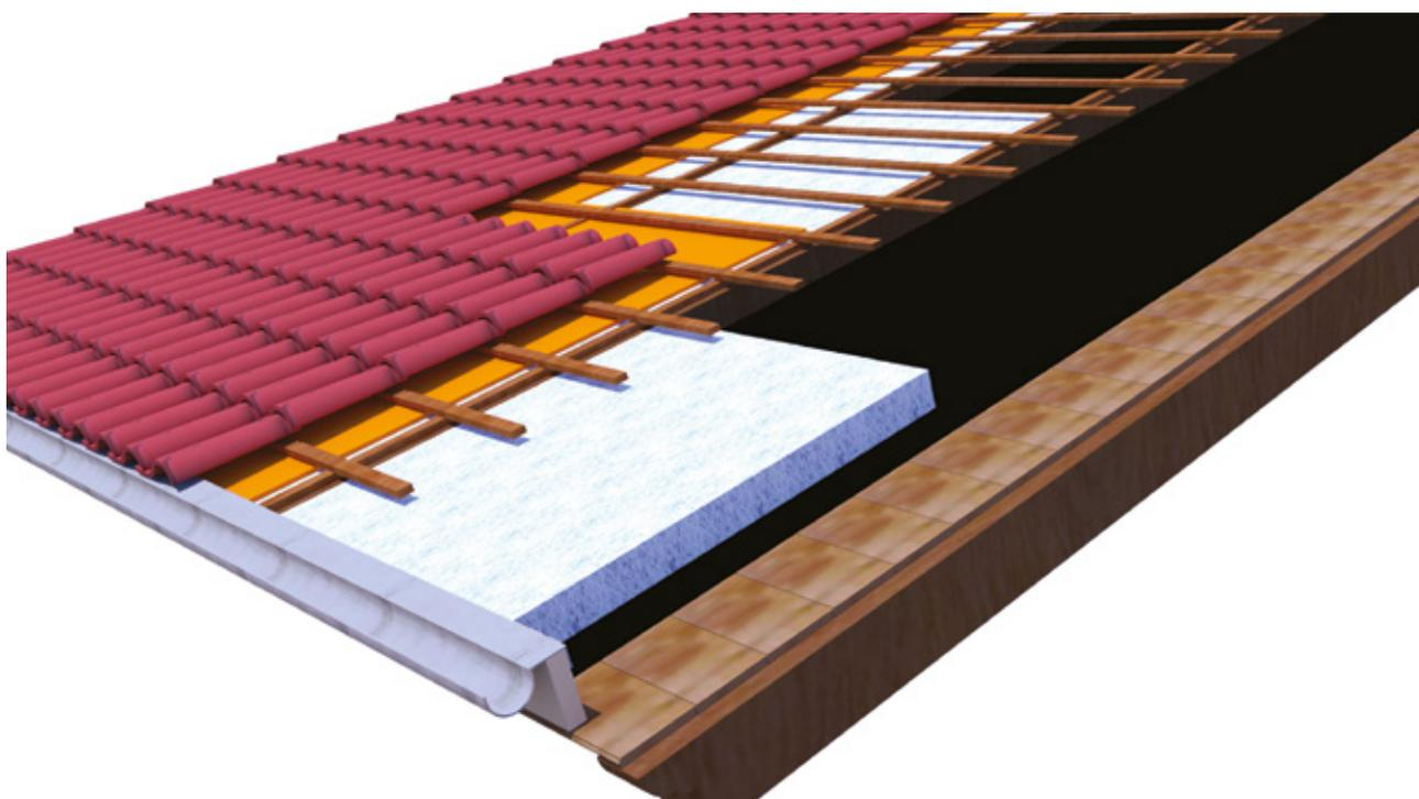
↑ *Isolmant Telogomma può essere utilizzato anche in caso di isolamento acustico delle coperture, per incrementarne il fonoisolamento. È un prodotto flessibile che può essere facilmente applicato anche su superfici non planari.*
