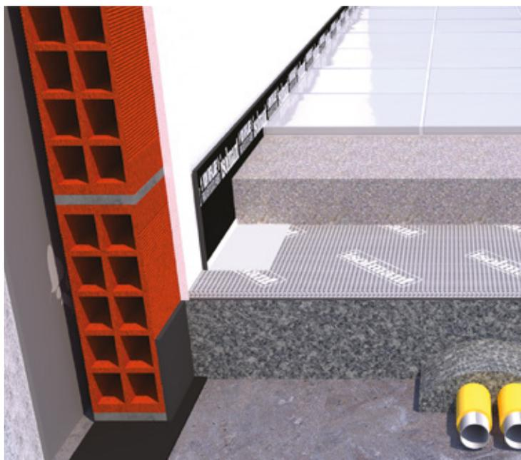
↑ *Struttura tradizionale bistrato: la tecnica costruttiva del sistema a massetto flottante, o galleggiante, consiste nel disaccoppiare il massetto di finitura e la pavimentazione dalle strutture limitrofe mediante uno strato di materiale elastico posto al di sotto del massetto di supporto alla pavimentazione, e lungo il perimetro del locale.*
