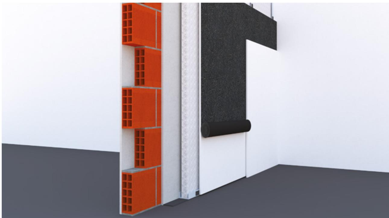
↑ *Isolamento acustico con inserimento di materiale massivo tra due lastre in cartongesso. Laddove il progettista o l'applicatore avessero necessità di utilizzare una soluzione diversa rispetto alle lastre accoppiate, è possibile utilizzare Isolmant Telogomma, che può essere applicato in testa alla lastra e facilmente tagliato alla base.*
