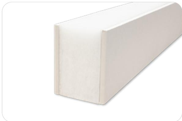
Setto acustico di completamento delle pareti interne mobili o in cartongesso da posizionare nel plenum tra la parete stessa e il solaio inferiore o tra la parete e il solaio superiore. Realizzato a sandwich con due lastre di cartongesso da 12,5 mm e pannello in IsolFIBTEC FLC (fibra di poliestere riciclata e termolegata da 80 mm).
