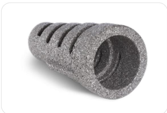
Silenziatore acustico brevettato in polipropilene espanso poroso (P-EPP) ad elevato potere fonoassorbente e bassa conducibilità termica. La forma cilindrica a diametri decrescenti caratterizzata da dimensioni ridotte (diametro maggiore 160 mm, lunghezza 350 mm) consente una semplice e rapida installazione. Griglie non incluse. Da posizionare con l'apertura verso il lato interno della parete.
