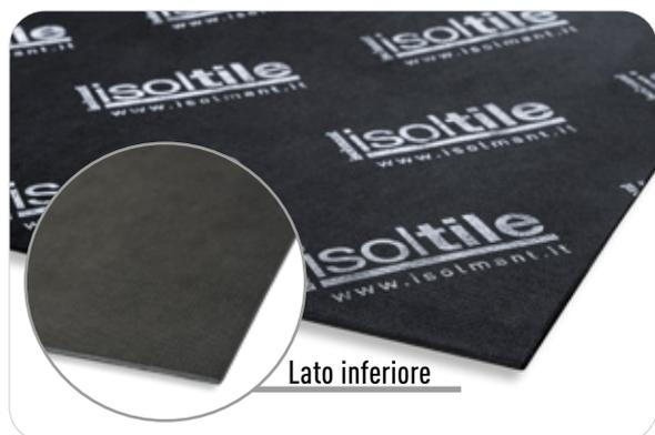
Isolmant IsolTile BV è costituito da polipropilene Isolmant reticolato fisicamente ad alta densità, rivestito sul lato superiore con speciale FIBTEC XP1 (geotessile tecnico in polipropilene, di colore nero, serigrafato e calandrato) e sul lato inferiore da FIBTEC XP2 (geotessile tecnico in polipropilene, di colore nero, calandrato, con barriera vapore -  $S_d > 40$  m).
