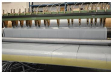
In funzione del tipo di materiale (standard, densità, spessore, ecc.) è possibile richiedere l'adesivizzazione su un lato oppure su entrambi ed il taglio longitudinale (in fasce) indicandolo con dovuto anticipo in fase di ordine. I tempi necessari alla lavorazione richiesta saranno comunicati di volta in volta. Il quantitativo minimo assoggettabile a lavorazione è un rotolo oppure una confezione.
