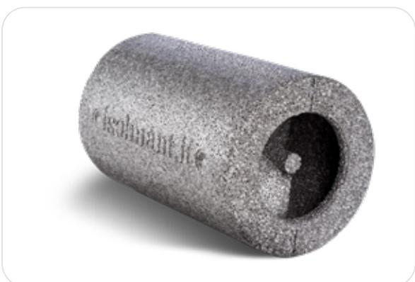
Silenziatore acustico brevettato in polipropilene espanso poroso (P-EPP) ad elevato potere fonoassorbente e bassa conducibilità termica, di forma cilindrica per una semplice e rapida installazione. Lunghezza 32 cm, diametro 19,4 cm. Griglia non incluse. Il prodotto è simmetrico (può essere posato in entrambi i versi).
