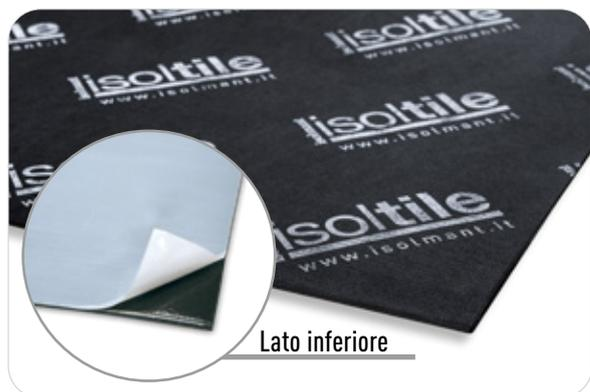
Isolmant IsolTile AD è costituito da polipropilene Isolmant reticolato fisicamente ad alta densità, rivestito sul lato superiore con speciale FIBTEC XP1 (geotessile tecnico in polipropilene, di colore nero, serigrafato e calandrato) e sul lato inferiore da uno strato adesivo di posizionamento, specifico per la posa su pavimentazione esistente.
