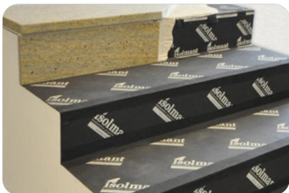
Isolmant Kit Scale è composto da teli di IsolTile Classic di misura standard per alzate, pedate e ripiani intermedi, da rifilare in cantiere per adattarli alla superficie specifica. Il KIT contiene anche la fascia di giunzione dei teli e la fascia laterale per il disaccoppiamento della scala dal vano scala, indispensabili per il completamento dell'isolamento acustico.
