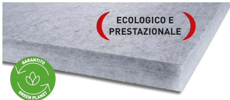
Prodotto composto da un pannello di ISOLFIBTEC PFT (fibra riciclata in tessile tecnico di poliestere a densità crescente lungo lo spessore, dalle elevate prestazioni termiche e acustiche). Di durata illimitata, atossico, ecologico. Pannello a tutta altezza per una posa facilitata.
