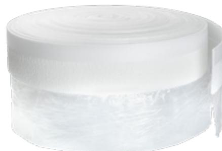
Fascia verticale in polietilene reticolato espanso di spessore 8 mm, colore bianco e altezza 15 cm. Adesivizzata per 7,5 cm di altezza, e dotata di film trasparente per il sormonto sul pannello radiante. Specifica per l'utilizzo con Isolmant UnderPlus Black.E Radiante BV e Isolmant UnderSpecial Radiante BV.
