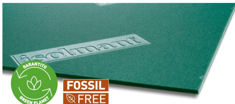
Strato resiliente in Isolmant Special Serie R Fossil Free completamente sostenibile e proveniente da fonti rinnovabili, di colore verde, gofrato e serigrafato sul lato superiore, caratterizzato da una migliore e calibrata qualità della cellulazione del polietilene.
