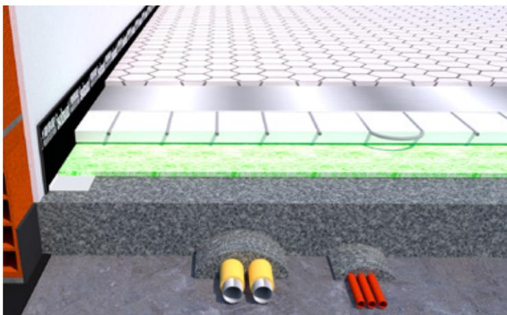
Per queste tipologie di struttura Isolmant Fibra HD garantisce ottime prestazioni di isolamento acustico in sistemi a secco con sottofondi granulari e lastre di gessofibra, fibrocemento o pannelli a base legno, ma può essere utilizzato anche con massetti gettati.
