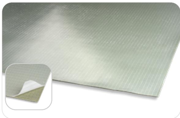
Il prodotto per incollare senza colla, l'innovazione di Isolmant per una posa ibrida che unisce la stabilità della posa incollata con la velocità e la pulizia della posa flottante. La pavimentazione viene ancorata direttamente allo strato superficiale di adesivo tenace presente sul prodotto, senza che si renda necessario l'uso di collanti. Ideale anche per LVT e SPC. Prodotto 100% naturale, certificato Blue Angel.\*
