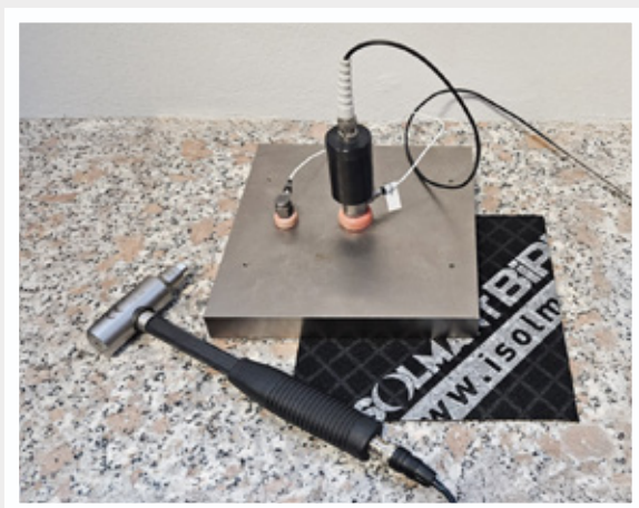
← Strumento per la misurazione della rigidità dinamica con doppia metodologia: shaker e martello dinamometrico.
