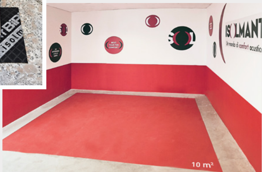
→ Camera di prova Isolmant - Vista dell'interno avente una superficie di 10 m 2 come richiesto dalla normativa vigente.
