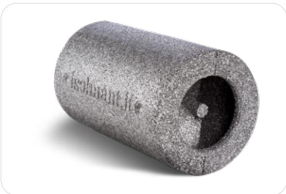
Silenziatore acustico brevettato in polipropilene espanso poroso (P-EPP) ad elevato potere fonoassorbente e bassa conducibilità termica, di forma cilindrica per una semplice e rapida installazione. Lunghezza 32 cm, diametro 19,4 cm. Griglie non incluse.
